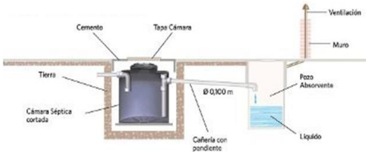
Ilustración 6. Detalle Típico del Sistema de Tanque Séptico
