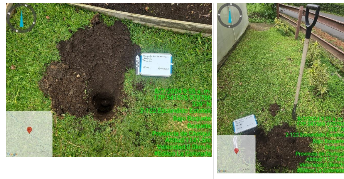
Fig. 8. Excavación de dos pozos de sondeo
