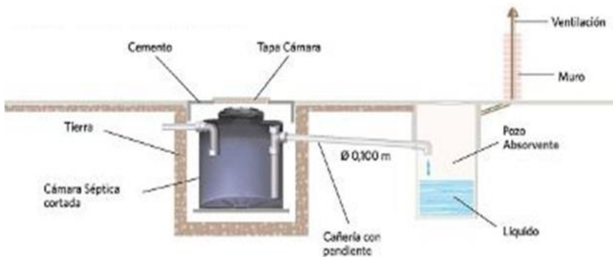
Ilustración 6. Detalle Típico del Sistema de Tanque Séptico
