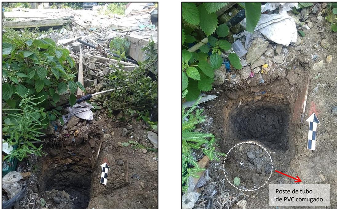
Figura 7. Sondeo 1 excavado hasta el nivel del agua 80 cm bajo el suelo.
