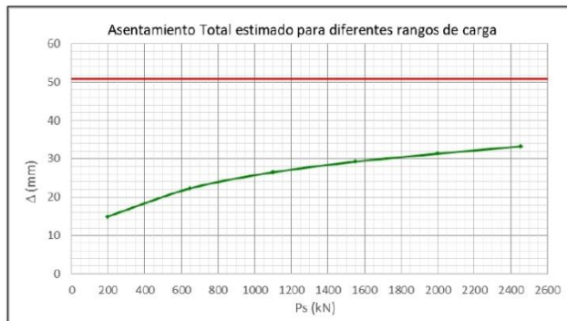
Figura 10 – Asentamiento estimado – (cumpliendo ambos criterios).
