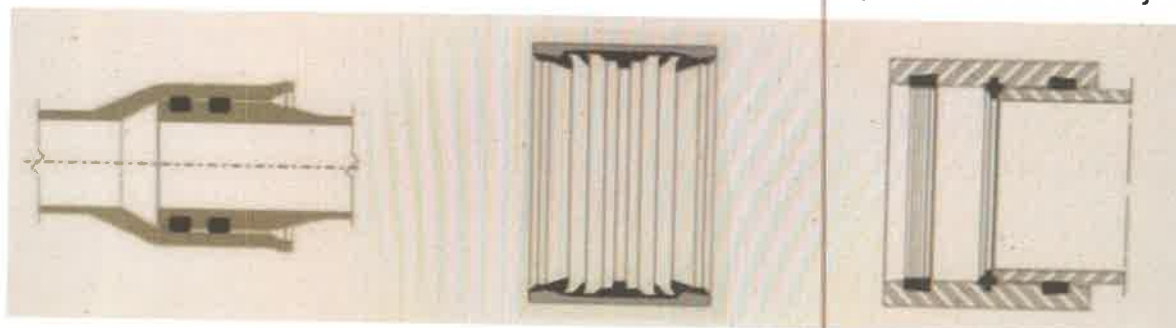
Uniones típicas de las tuberías PRFV
