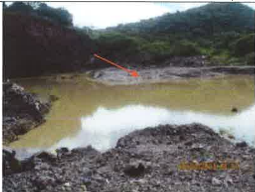
13. Frente de extracción de piedra de cantera, se observa la roca expuesta, para la perforación y voladura (Izq.). Ninguna de las pozas tiene salida a drenajes colindantes, por lo que no se aporta sedimento a las zanjas de drenaje del sector.
