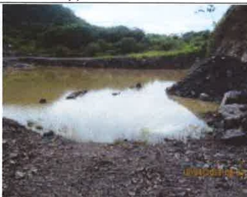
13. Frente de extracción de piedra de cantera, se observa la roca expuesta, para la perforación y voladura (Izq.). Ninguna de las pozas tiene salida a drenajes colindantes, por lo que no se aporta sedimento a las zanjas de drenaje del sector.
