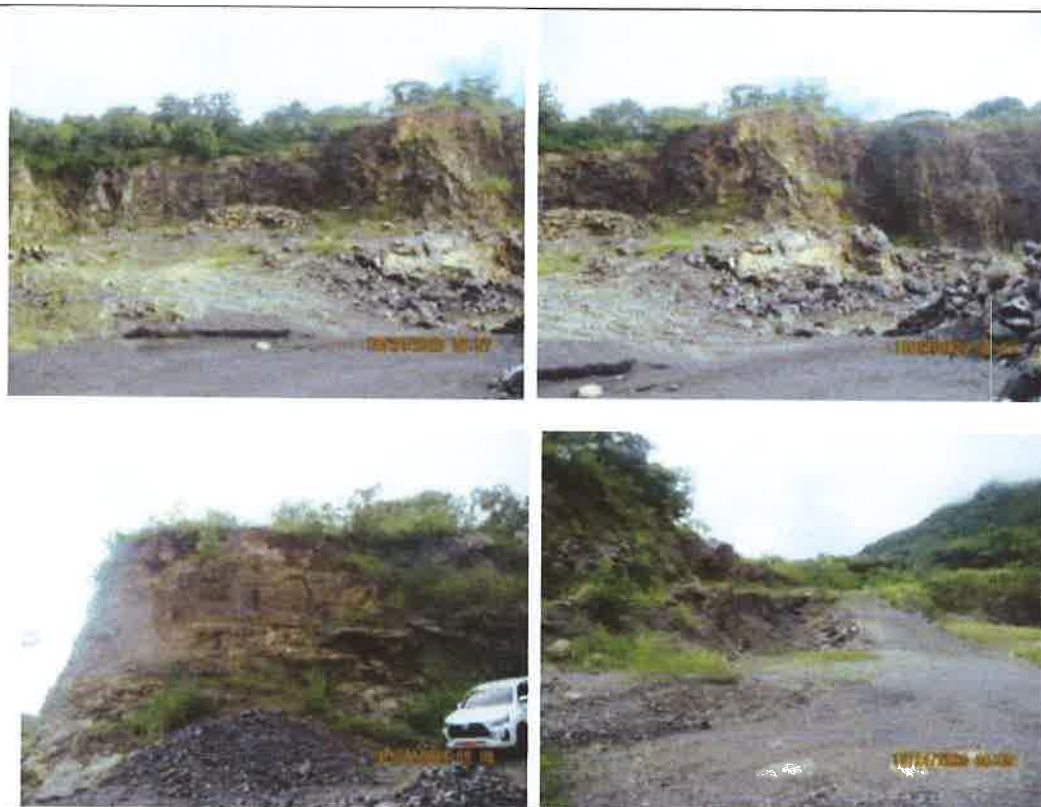
14. Estrato de tosca de sobrecarga, para la extracción (Arriba). Estratos de tosca en el frente de extracción que ha sido dejado debido a que no se puede comercializar la tosca, promoviendo una extracción selectiva no ordenada.
