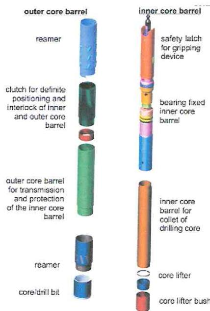
**Figura No. 6: Sistema de Doble Tubo y Broca de Diamante**
