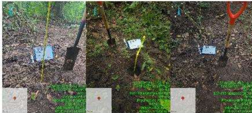
Fig.10. Excavación de un pozo de sondeo.
