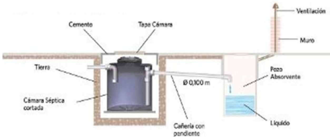
Ilustración 6. Detalle Típico del Sistema de Tanque Séptico
