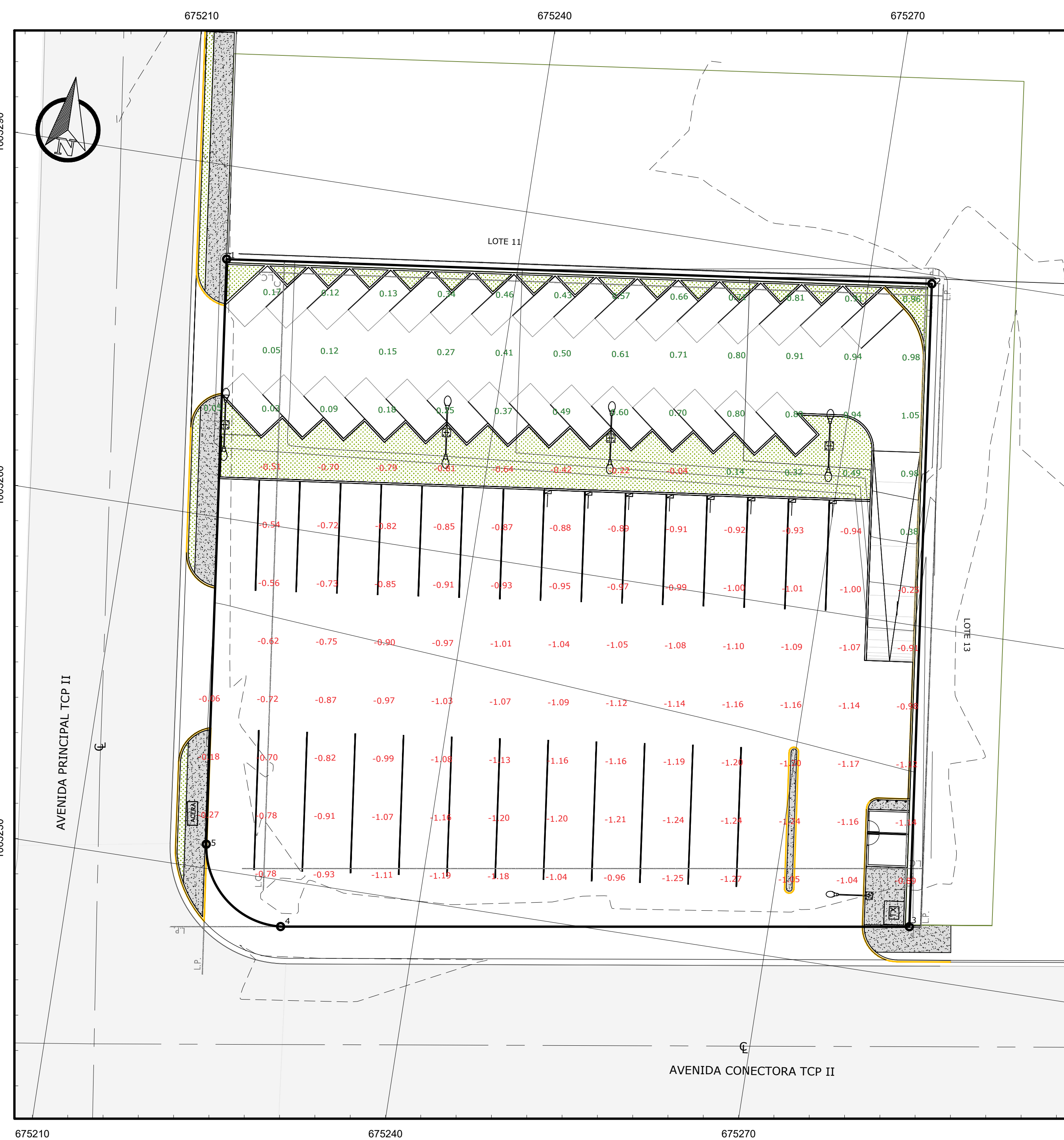
NIVELES DE CORTE Y RELLENO ESC: 1:250
