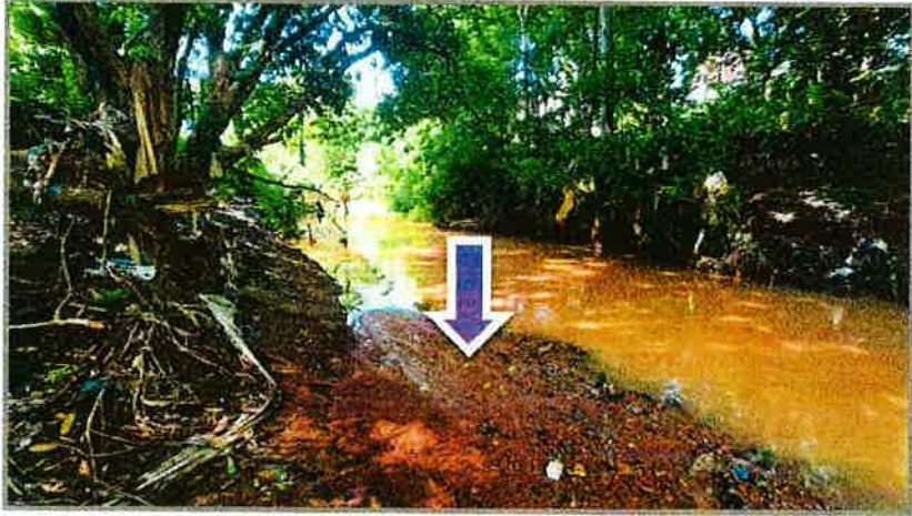
Foto N°7 – Vista río abajo de la sección de aforo. Se observa aumentos del nivel de agua, producto del aumento en el caudal, así como evidencia de considerables cantidades de sedimento depositado.
