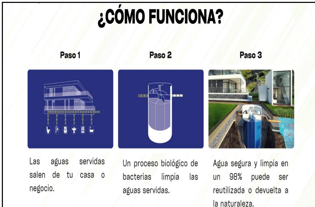
Figura 6. Funcionamiento del Sistema de tratamiento de aguas residuales para cada lote.
