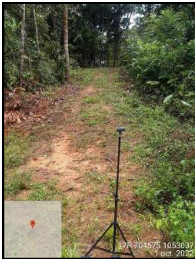
Figura 6-7. Monitoreo de ruido ambiental para línea base por equipos debidamente calibrados. Fuente: Equipo Consultor
