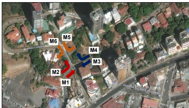
9 Esquema de localización de otras vías circundante al proyecto donde se realizaron movimientos de aforos vehiculares. Fuente promotor
