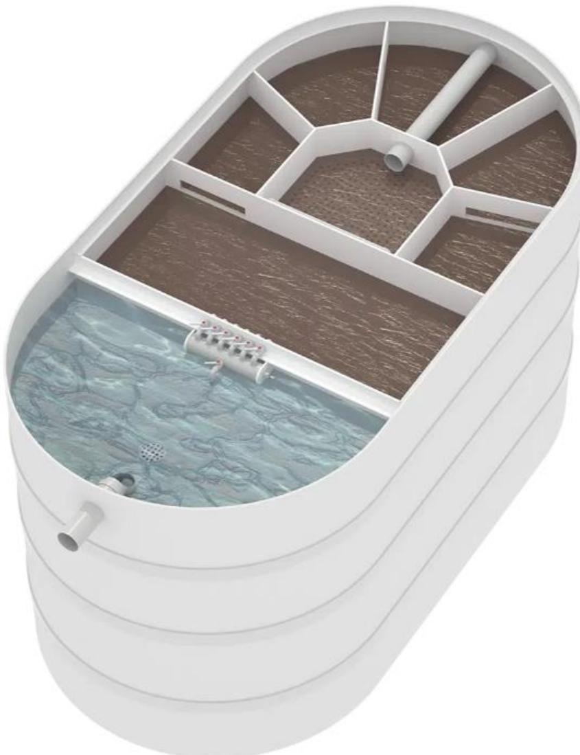
Los sistemas ATO30 – AT0225 de depuración de aguas residuales han sido diseñados para ofrecer soluciones de tratamiento centralizadas y semi-centralizadas en el rango de 4,5 a 75 m<sup>3</sup> al día (30 – 500 PE). Estos sistemas compactos no requieren obras civiles y pueden ser ampliados mediante la instalación de múltiples unidades en paralelo. Son ideales para urbanizaciones, pequeñas comunidades, hoteles, restaurantes y otros lugares donde el espacio es limitado.
