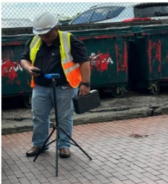
Foto 3. Medición de calidad de aire en el proyecto y comunidad como punto de referencia
