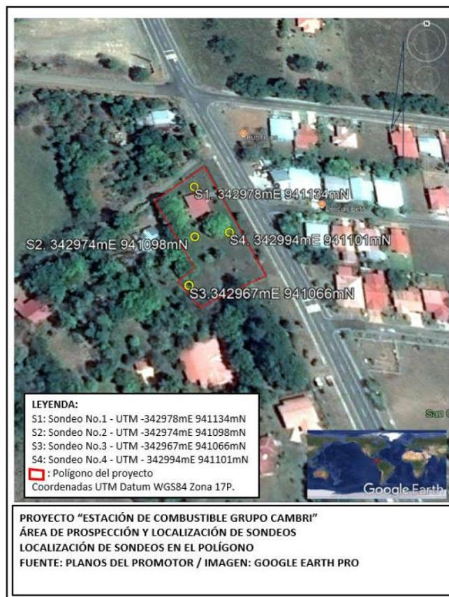
**Figura No.5.** Imagen muestra el área de prospección y la localización de los sondeos (1, 2, 3, 4). **Fuente:** Google Earth Pro.
