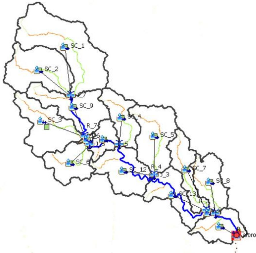
Figura 4.7. Modelo subcuencas del río Abajo en HEC-HMS4.12
