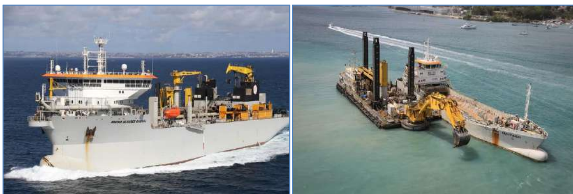
Figura 67. Equipo de Dragado: TSHD (izq) – BHD y SHB (der)
