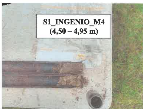
Figura 9. Ensayo SPT S1_Ingenio_M4 (Entre 4,50 – 4,95 m)
