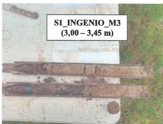
Figura 8. Ensayo SPT S1_Ingenio_M3 (Entre 3,00 – 3,45 m)
