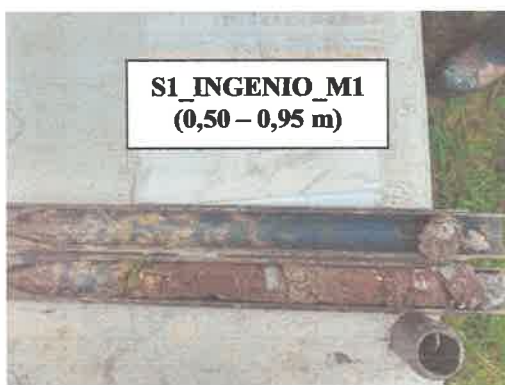
Figura 6. Ensayo SPT S1_Ingenio_M1 (Entre 0,50 – 0,95 m)
