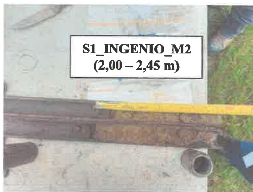
Figura 7. Ensayo SPT S1_Ingenio_M2 (Entre 2,00 – 2,45 m)
