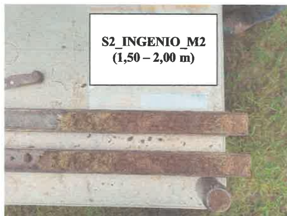
Figura 12. Ensayo SPT S2_Ingenio_M2 (Entre 1,50 – 2,00 m)
