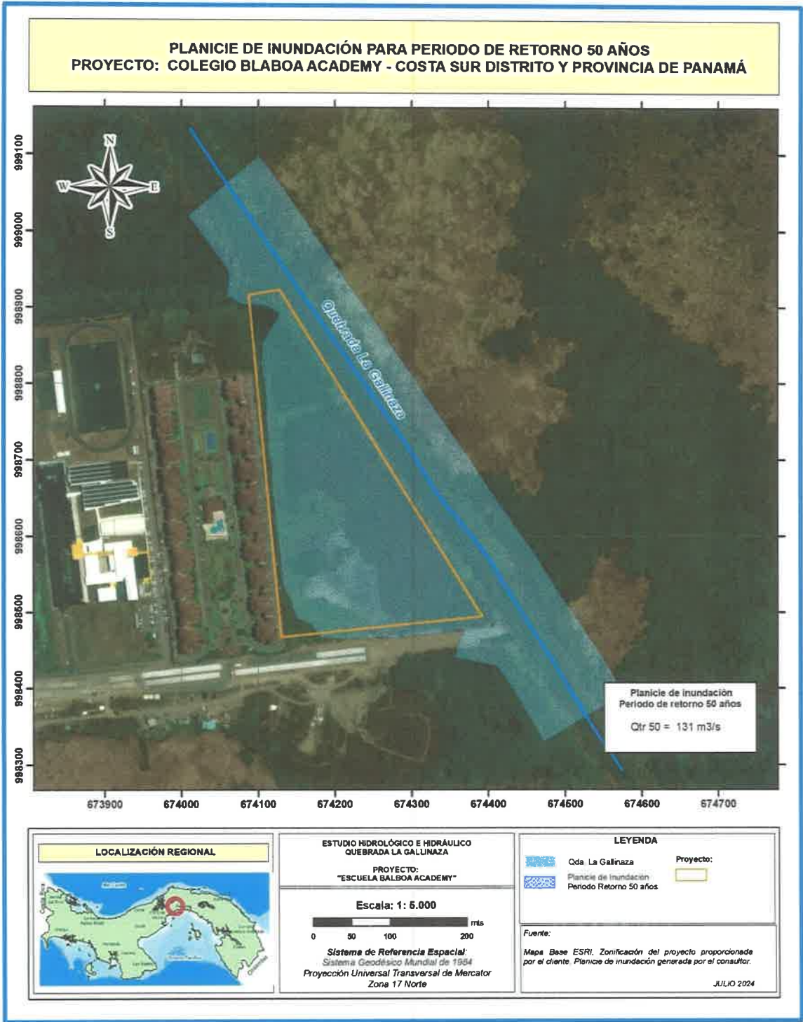
Figura 16. Mapa de planicie de inundación de modelación hidráulica para un periodo de retorno de 1 en 50 años.
