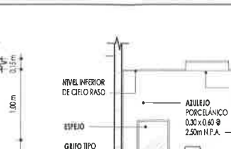
5 ELEVACIÓN 1 BAÑO TIPO A ESCALA: 1:33 LOCALES COMERCIALES
