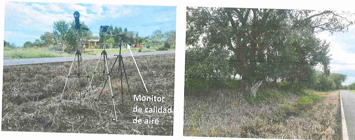
**Fotografías:** Izquierda, equipo de medición ambiental instalado junto a la alambrada frontal del polígono del proyecto y a unos 8 metros de la carretera Ocú – Las Minas. Se observa al fondo, al otro lado de la vía, la única vivienda en las cercanías del proyecto. Derecha, vista de la carretera y de la servidumbre en dirección al poblado de Ocú.
