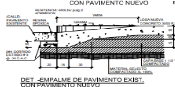
DET. EMPALME DE PAVIMENTO EXIST. CON PAVIMENTO NUEVO ESC. 1:20
