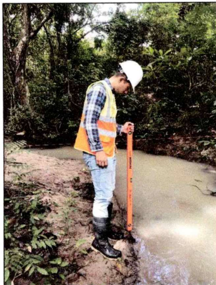
Imagen No. 21. Vista del momento en que se realizaba las mediciones de aforo del cauce del río San José
