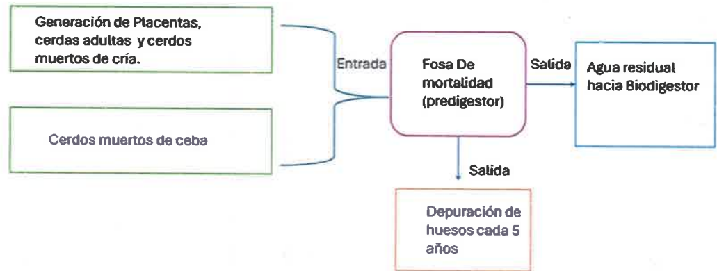
DIAGRAMA DE FLUJO PARA EL MANEJO DE MORTALIDAD Y PLACENTAS UTILIZANDO UN SISTEMA DE PREDIGESTOR
