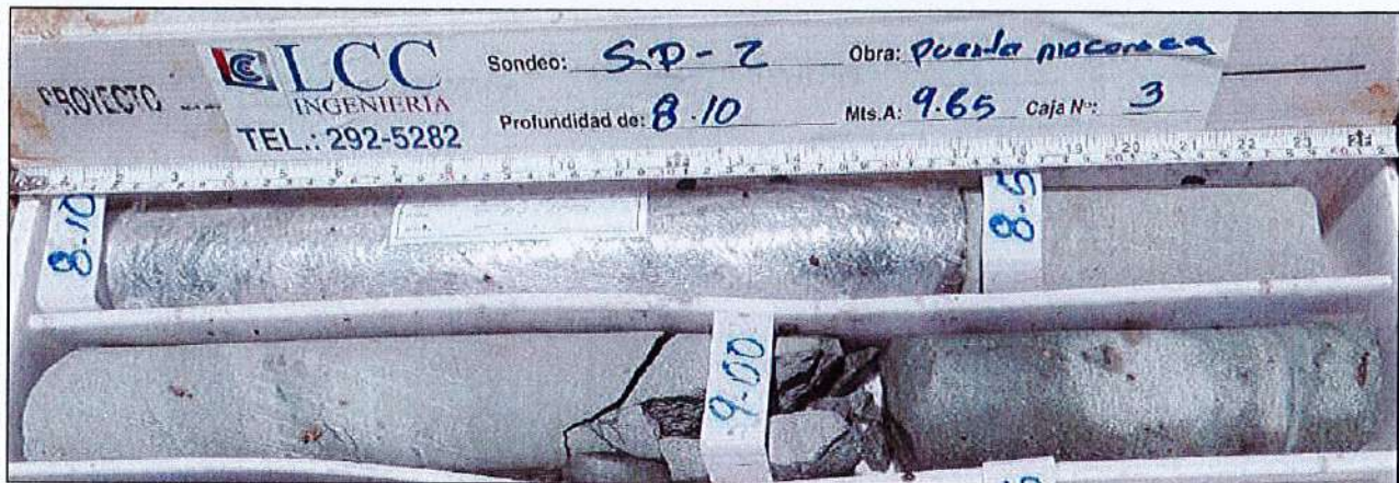
Figura 12. Muestra del sondeo SP-02 entre 8.10 y 9.30 m. Roca Sana (UG5).
