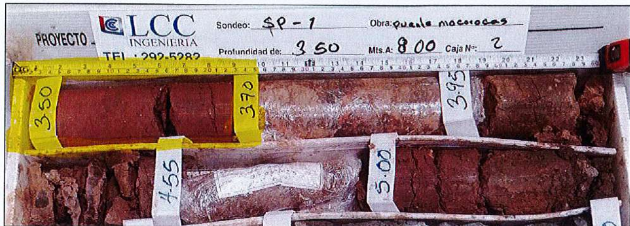
Figura 9. Muestra del sondeo SP-01 entre 3.50 y 3.70 m. Residual blando (UG2).
