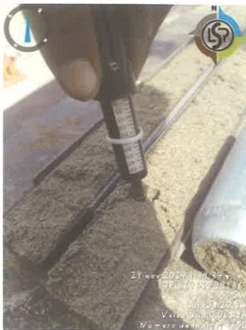
Fig 9.16. Prueba del penetrómetro sondeo 2(3.00-3.60 m).
