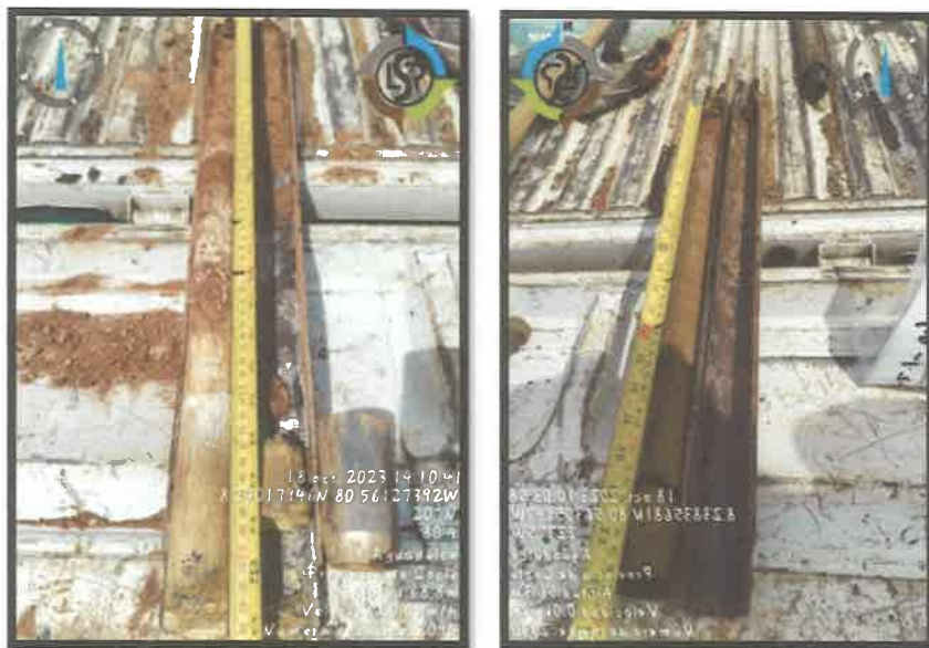
FIG.Nº2. CUCHARA DE SPT NORMALIZADO EN EL ENSAYO
