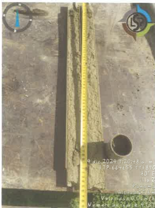
Fig 9.31. Recuperación de sondeo 4(0.60-1.20m) inicio.
