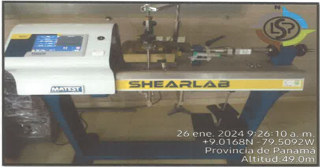
FIGURA N°10. EQUIPO DE CORTE DIRECTO MATEST.
