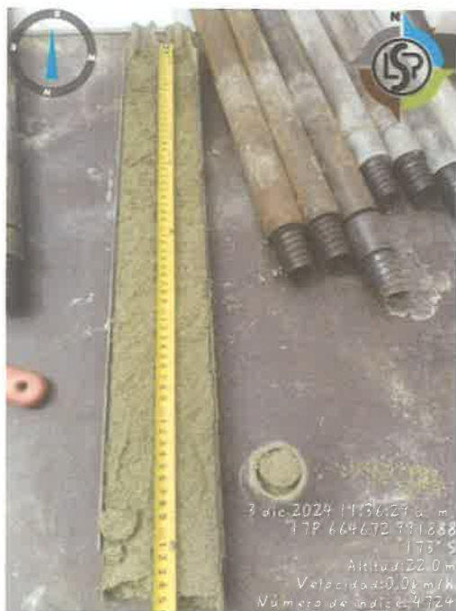
Fig 9.39. Recuperación de sondeo 5(0.60-1.20m) inicio.
