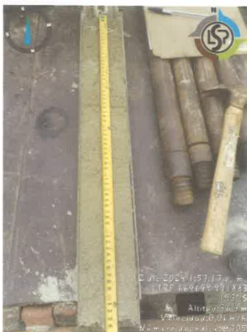
Fig 9.23. Recuperación de sondeo 3(0.60-1.20m) inicio.
