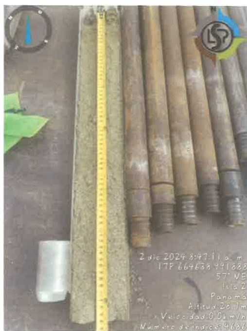
Fig 9.3. Recuperación de sondeo 1(0.60-1.20m) inicio.
