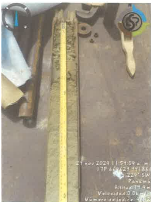
Fig 9.11. Recuperación de sondeo 2(0.60-1.20m) inicio.
