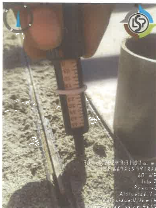
Fig 9.18. Prueba del penetrómetro sondeo 2(7.40-8.0 m).
