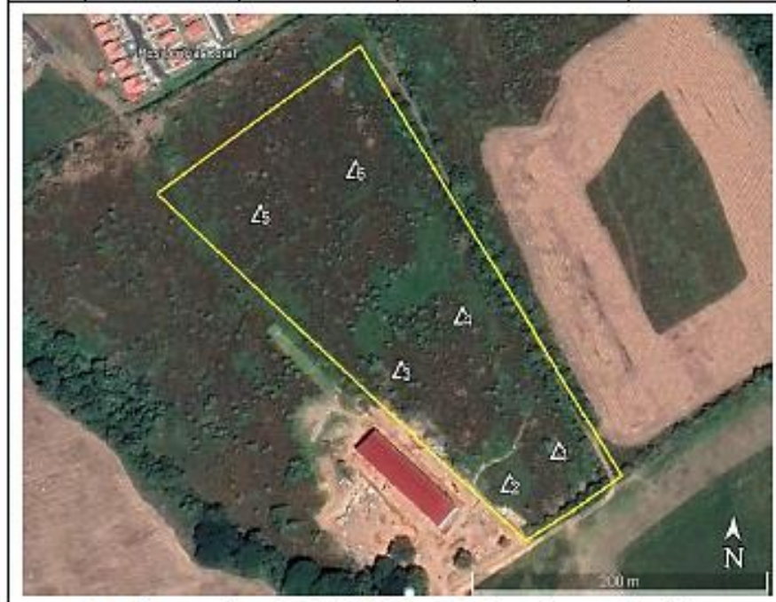
Área de proyecto vista en Google Earth y los sondeos efectuados y georreferenciados con sus respectivas coordenadas en el Sistema Geodésico Mundial (WGS 84).
