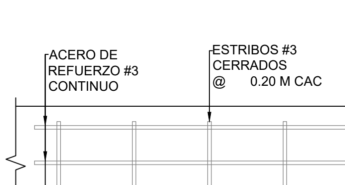
DETALLE DE VS-01 ESC. 1/10 ELEVACION LONGITUDINAL
