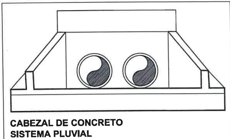
Esquema de obras de drenaje a establecer en los drenajes pluviales
