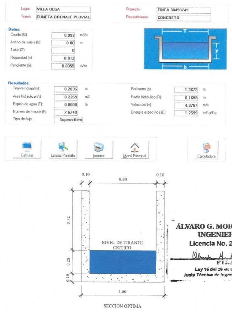
**K. DISEÑO DE PLUVIAL PARA ENTUBAMIENTO DEL DRENAGE PLUVIAL**
