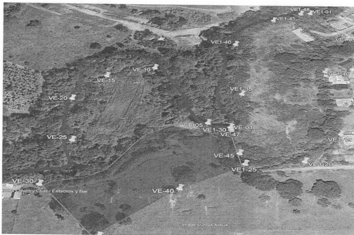
Imagen No.2: Área de corte y trabajos de terracería con banquetas (intervencion aproximada de 2.2 hectáreas).
