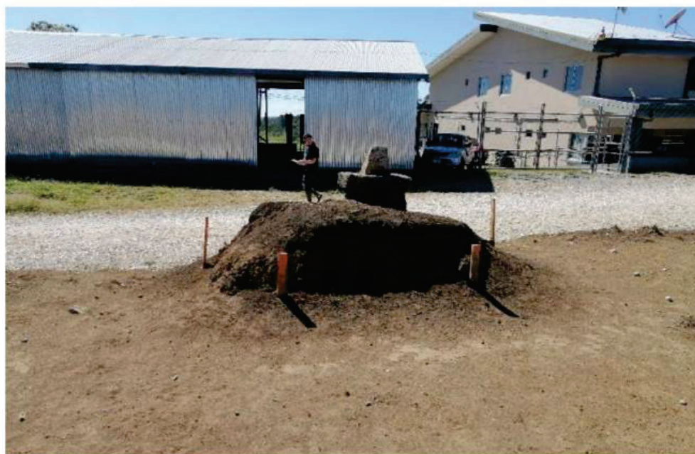
Figura 4.- El diferencial entre la altura del hito fronterizo y la superficie actual indica el volumen de suelo removido en la afectación previa.
