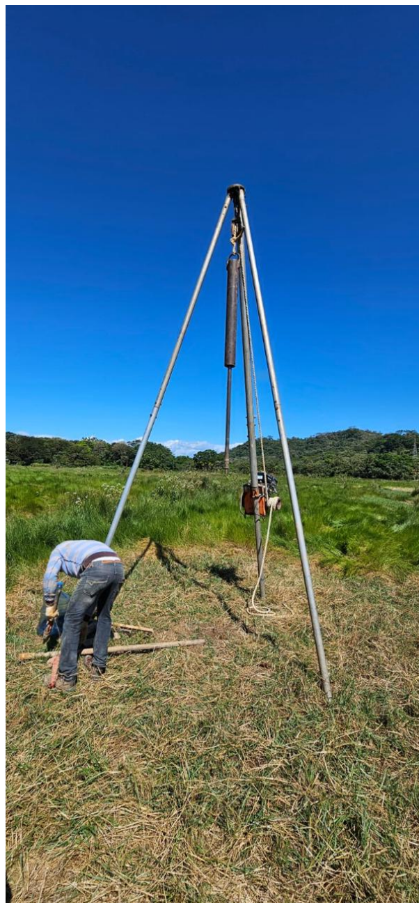
FOTO No. 118: ÁREA DE PERFORACIÓN No. 18 DE CAPACIDAD DE SOPORTE PARA SUPERMERCADO
