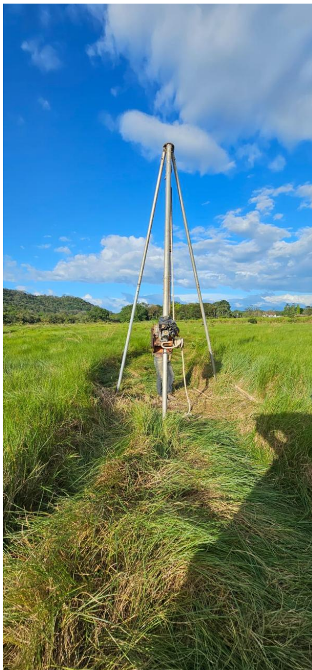
FOTO No. 90: ÁREA DE PERFORACIÓN No. 14 DE CAPACIDAD DE SOPORTE PARA SUPERMERCADO
