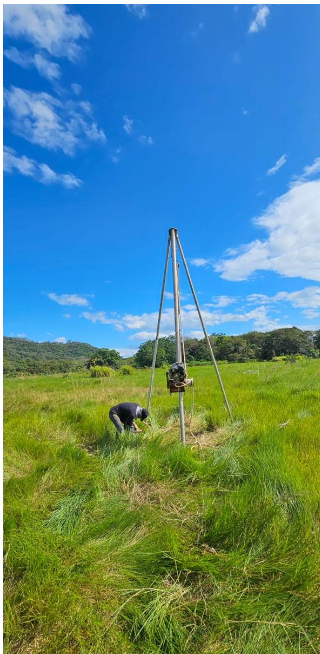
FOTO No. 111: ÁREA DE PERFORACIÓN No. 17 DE CAPACIDAD DE SOPORTE PARA SUPERMERCADO
