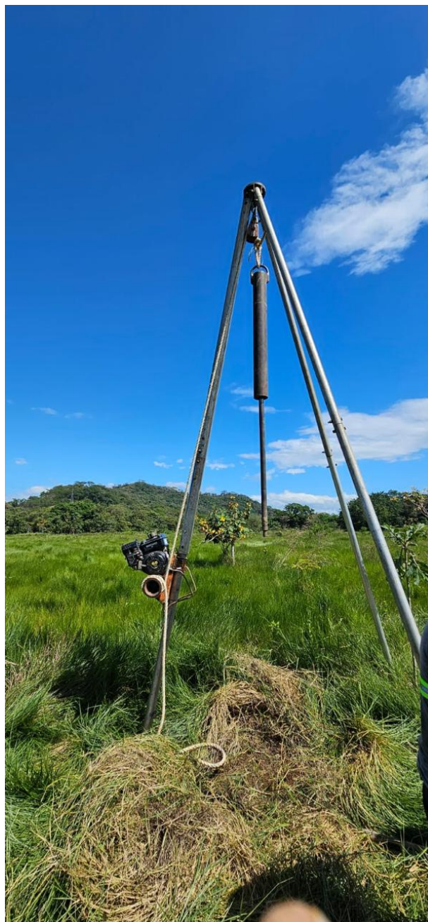
FOTO No. 97: ÁREA DE PERFORACIÓN No. 15 DE CAPACIDAD DE SOPORTE PARA SUPERMERCADO
