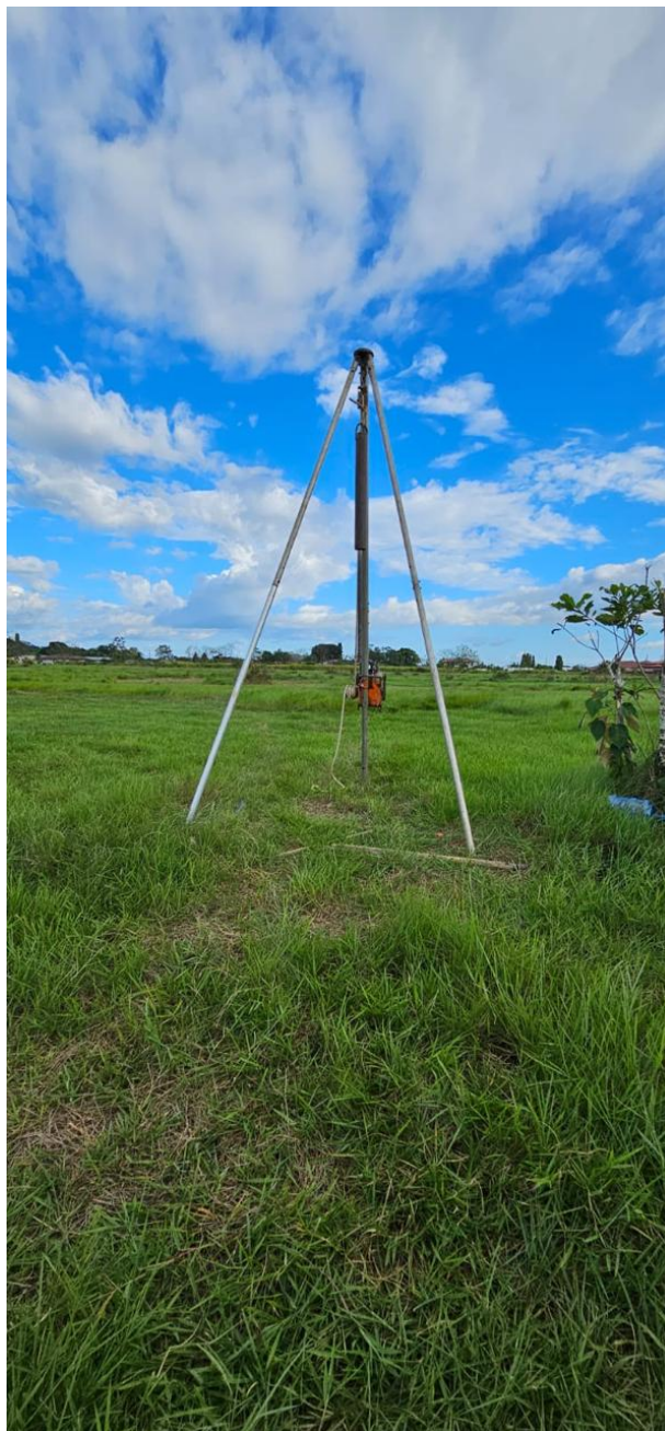
FOTO No. 104: ÁREA DE PERFORACIÓN No. 16 DE CAPACIDAD DE SOPORTE PARA SUPERMERCADO
