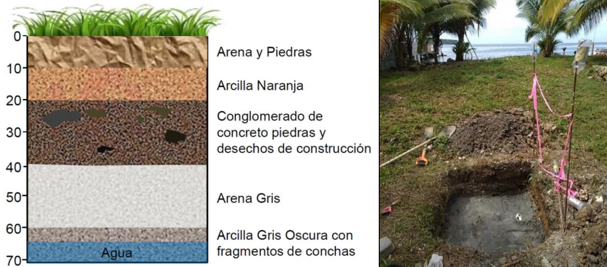
Figura 5.3.1. Sondeo realizado en el área del proyecto, y que evidencia la presencia de arena y piedra en los primeros 10 cm, arcilla naranja en los 10 y 20 cm, conglomerado de concreto piedras y desechos de construcción entre los 20 y 40 cm, arena gris entre los 40 y 60 cm, y arcilla Gris Oscura con fragmentos de conchas desde los 60 cm de profundidad del suelo, con evidencia del nivel freático próximo o superior a los sesenta y cinco centímetros de profundidad. Fuente: Datos de campo: Dr. D. Cáceres y Dr. G. Pearson. Isla Colón, dentro de la propiedad y finca del Proyecto BAMBUDA BOCAS TOWN PHASE 2. Ago., 2023, actualizado en marzo de 2025.
