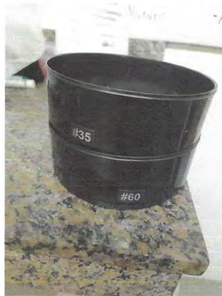
Imagen 3. Tamiz utilizado para separación de sedimento de muestras.
