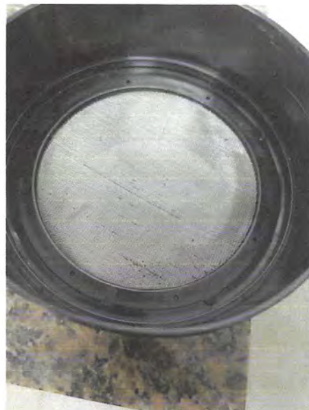
Imagen 4. Apertura de la malla del tamiz.
