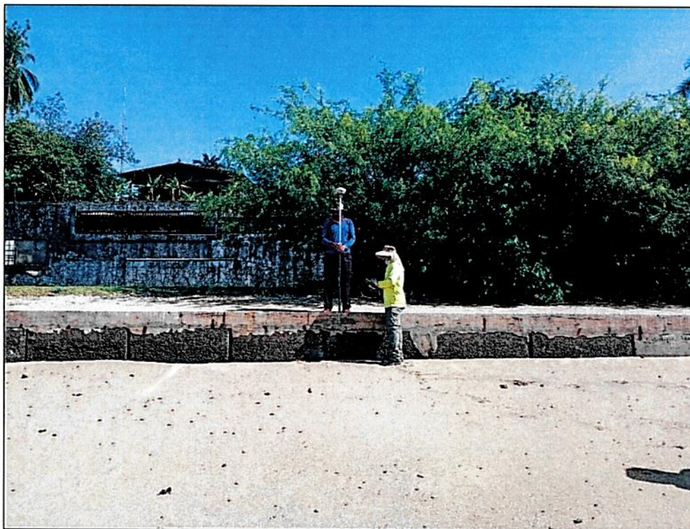
Imagen No.7. Levantamiento de la Línea de Alta Marea Ordinaria (LAMO).
