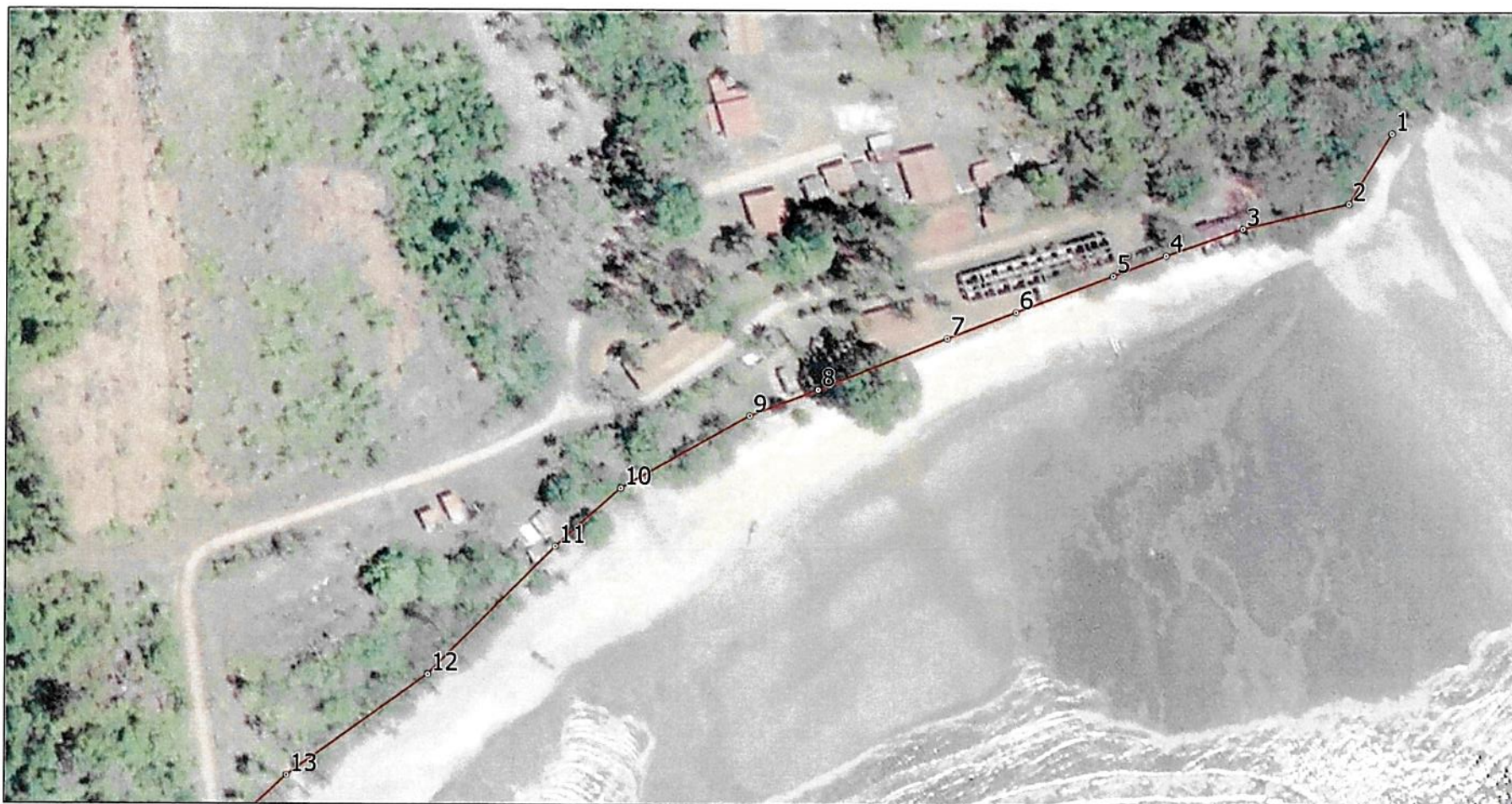
Imagen No.1. Primera sección de Línea de Alta Marea Ordinaria (LAMO) levantada por el IGNTG (La imagen satelital es solo con fines ilustrativos).
