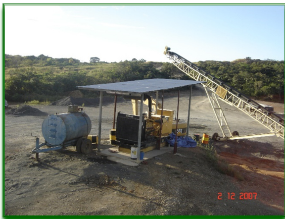
Imágenes de Planta eléctrica Caterpillar de 600 Kilovatios y Planta Trituradora con sus componentes
