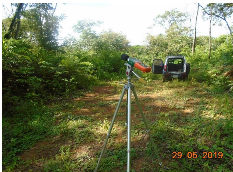
Fotografía 2. Sonómetro instalado en sitio de monitoreo.
