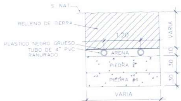
SECC. DE DRENAJE (12 TUBOS 4" P.V.C)
