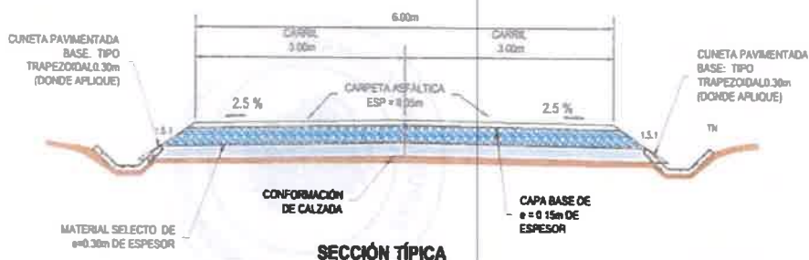
Imagen No. 1 - Sección típica recomendada.
